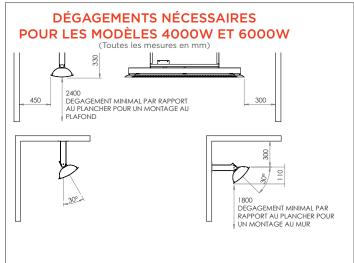
\*Alternativement, les supports de montage courts peuvent être utilisés pour le montage mural des modèles 4000W et 6000W et pour fixer l'appareil de chauffage plus près du mur. Les supports de montage courts doivent être achetés séparément.
